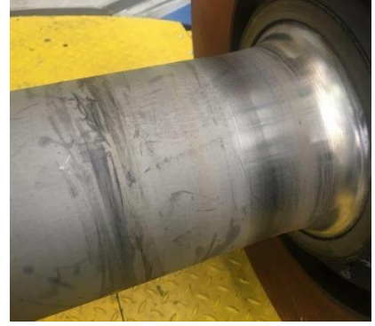
Fotos auf der mittleren und rechten Seite: Rost wird sichtbar, vergangenes Sandstrahlen und mechanische Schäden werden sichtbar
